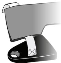
2. Befestigen Sie die weißen Klettbänder an den OP-Bettschienen, indem sie unter die Schiene geschlungen und die Enden der Klettbänder befestigt werden. (*Abbildung 3*)
